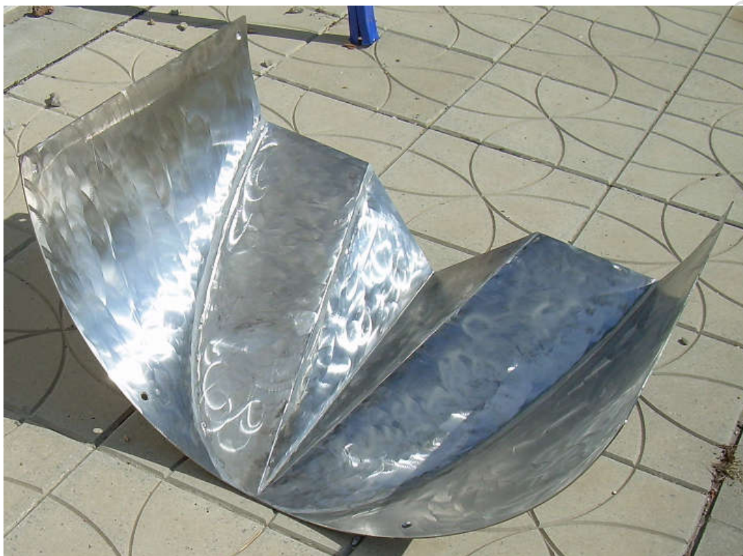
Фиг.2.1 Примерна конструкция на хидрометричното съоръжение с комбиниран измервателен преливник.
